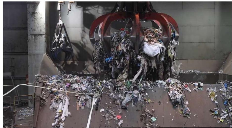
Figura 2 – Benna che carica uno dei tre forni del termovalorizzatore
